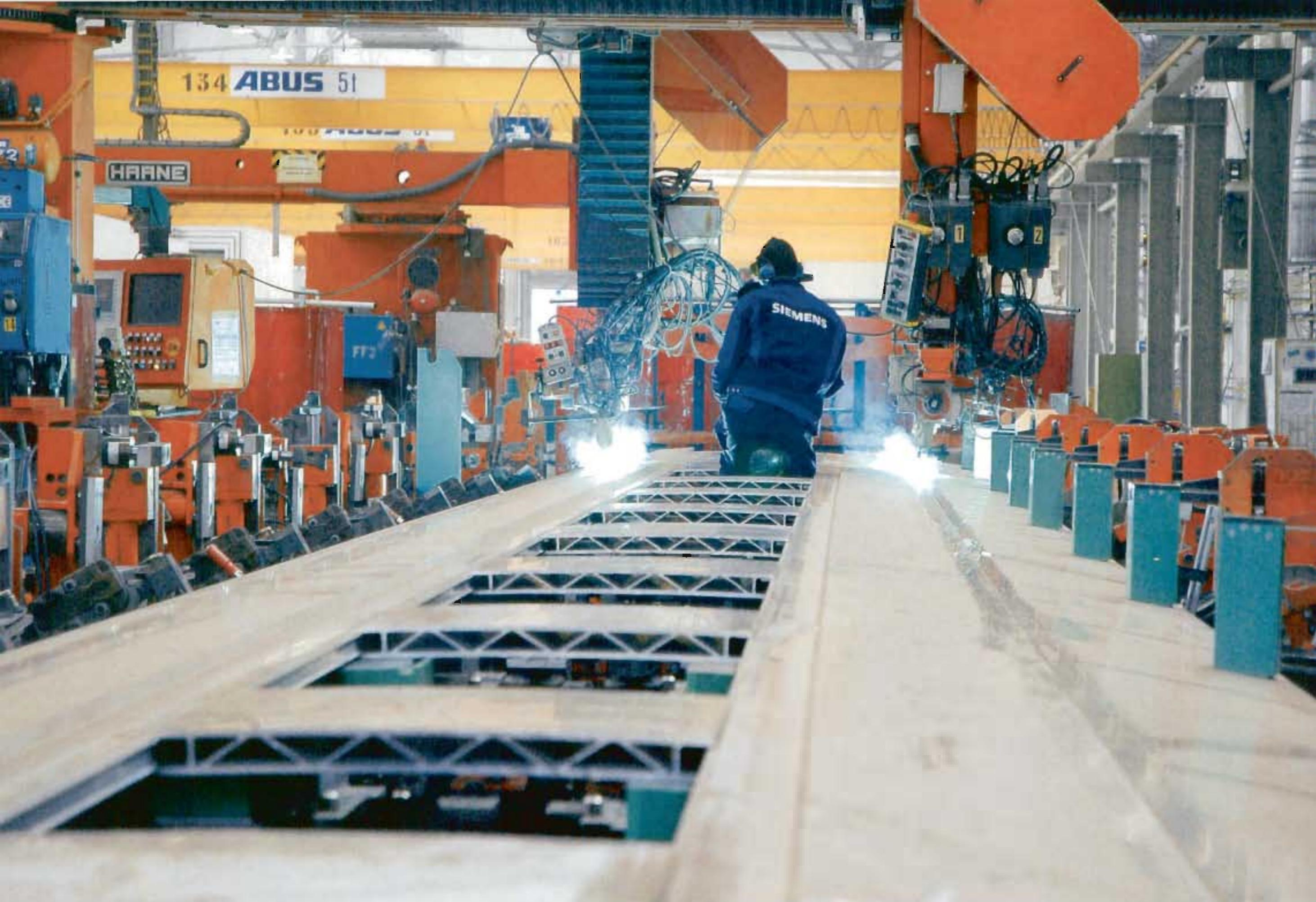
*Создание скоростного поезда начинается со сварки кузова вагонов из алюминиевых конструкций.*
