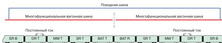
Рис. 20. Распределение системы шин TCN по вагонам на примере односистемного поезда B1
