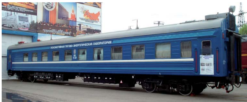
Современный скоростной вагон-лаборатория для тягово-энергетических испытаний локомотивов (фото О.Н. Назарова)
