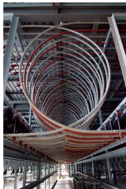
Уникальный групповой стенд для испытаний тормозного оборудования на Экспериментальном кольце ВНИИЖТа в Щербинке
