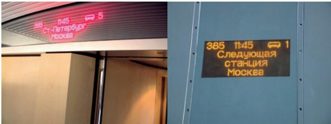
**Bild 5:** Beispiele für eine Zugdatenanzeige innen (links) und außen (rechts).
