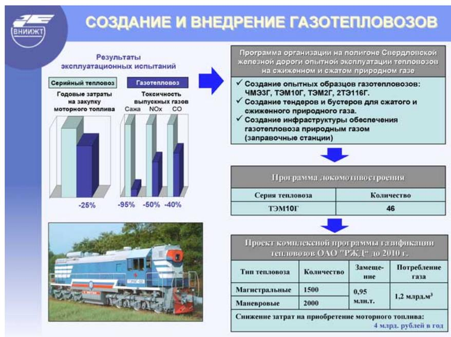
ге показали возможность замещения 50 % дизельного топлива газом, что соответствует экономии 25 % затрат, а также снижение токсичности выхлопных газов в 1,5 — 2 раза. Полученные результаты позволили выбрать в качестве стратегического ориентира ОАО «РЖД» применение газотепловозов. Программой локомотivостроения предусмотрена поставка партии газотепловозов ТЭМ18Г (ТЭМ10Г).
