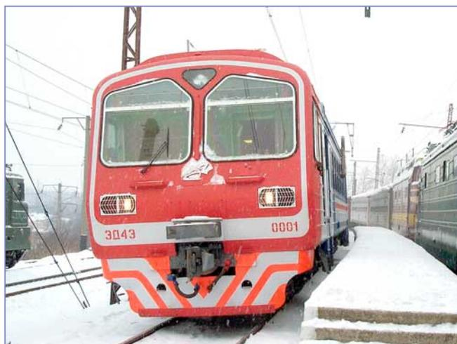
Электropоезд постоянного тока ЭД43 с энергосберегающим тяговым приводом
